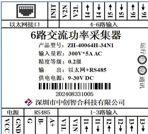
图 4.5、产品引脚定义图(以太网接口)
