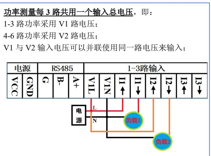
图 4.6、2 路功率测量接线示意图
