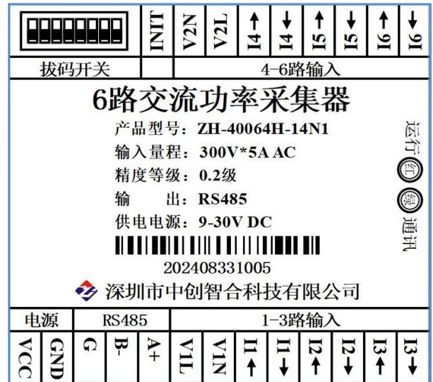
图 4.4、产品引脚定义图(RS485 接口)
