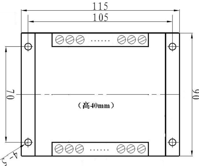
图 4.3、产品尺寸图（高：40 mm）
